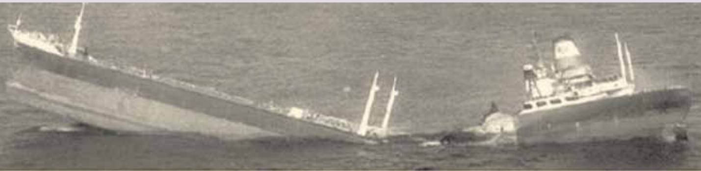
1968年6月13日世界光榮號油輪被瘋狗浪撕裂成兩半正在沉沒的情況 (資料來源：原出自南非網頁，爾後出現在美國劉博士網頁，但都已移除)
