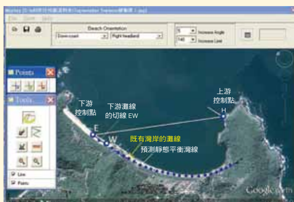
在啟動 MEPBAY 程式後，下載巴西 Santa Catarina 省的 Taquarinas-Taquaras 海岸影像，選定上、下游控制點（H、E）及下游灘線的切線點（W）後，在螢幕上可見到既有灣線與預測的靜態平衡灣線吻合，因此可判定是「靜態平衡灣岸」。（圖片來源：Google Earth 影像）
