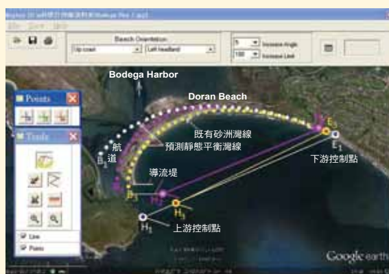
美國加州的 Doran 砂洲海灘屬於動態平衡灣岸，因為既有灣線在以南導流堤堤頭為上游控制點（紫色點 H2）所預測的靜態平衡灣線（紫色點線 E2B2）的海側；若其上游沿岸漂砂或灣內河川輸砂全部消滅一即「零漂砂」情況，既有灣線可能後退到預測的靜態平衡灣線（白色點線 E1B1）；最佳改善策略是延伸北導流堤到 H3 點，使既有砂洲灣線轉型為自然的靜態灣線（黃色點線 E3B3）。（圖片來源：Google Earth 影像）
