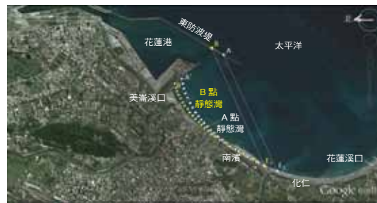
花蓮港東防波堤延伸導致化仁與南濱海岸侵蝕及北濱淤積，若東防波堤由A點退到B點（減少250公尺），則預測的新靜態平衡灣線（EB'）趨近既有灘線，海岸侵蝕幅度可望大幅減輕。（圖片來源：Google Earth 影像）
