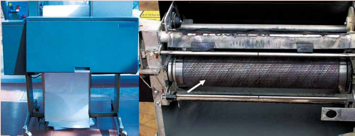
行列式印表機是把許多字模同時排列在長型滾輪上（如箭頭所示），一次可以列印一整行。（圖片來源：維基百科 http://en.wikipedia.org/wiki/Line_printer ）
