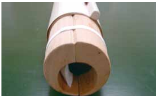
藉著加大捲軸的半徑，可以減輕在收藏期間的塑性形變和內在曲率。
