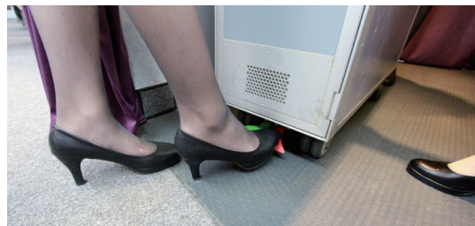
客艙內的餐車看似簡單，操作上卻有很多特殊設計。當空服員踩下綠色踏板時（上），會解開餐車的煞車，如果要在定點服務，則要踩下紅色的踏板固定餐車（下）。
