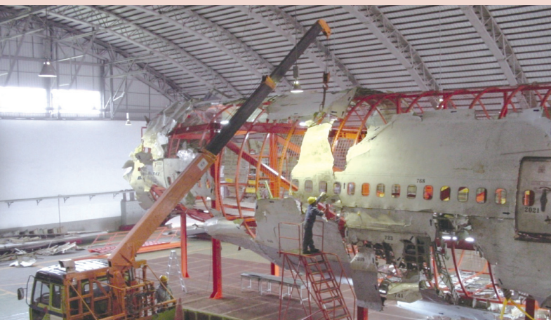
調查小組在桃園棚場內把 34 片飛機殘骸固定在結構模型框架上，完成三維殘骸硬體重建。
