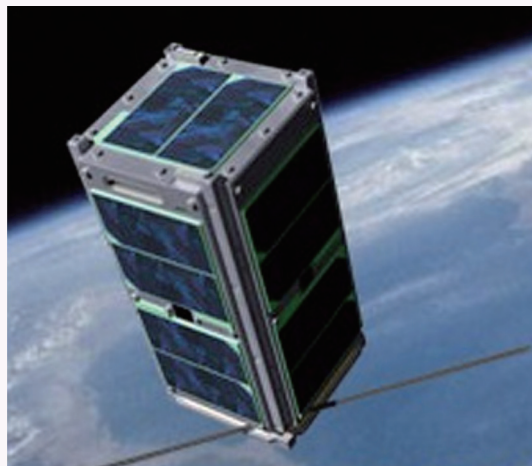
PACE 衛星 成功大學自製的第一枚 2U 立方衛星。
