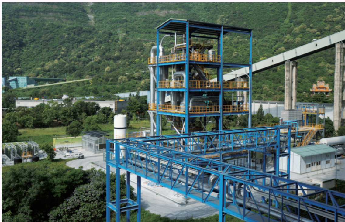
工研院於台泥和平廠建立的 1.9 MW th 的鈣迴路先導型試驗廠
