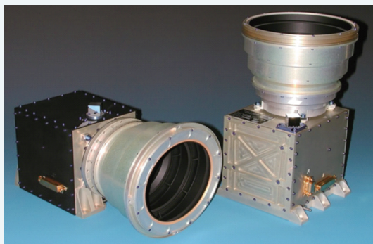
衛星星象儀可對星空照相並求得衛星的姿態
