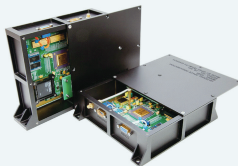
國內研製的第一個太空級 GPS 導航接收機將搭載於福衛七號自主衛星上
