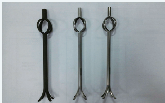
振動磨削前、中、後骨釘表面的情形。
