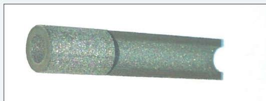
採用選擇性雷射熔融工法製成的鈦合金 (Ti6Al4V) 管件 (部分已剖開方便觀察管內的表面狀態)，因為材料顆粒熔融燒結所衍生的粒狀紋路清晰可見，工件表面顯得相當粗糙。
