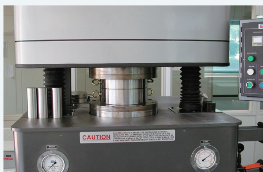
進行磨料流動加工時，先把被加工物置於治具內，再把治具組放置於機台工作台上方的上、下磨料缸之間並夾緊。
