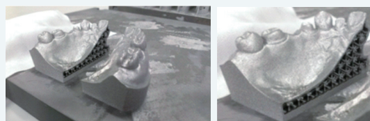
3D 列印快速成形於齒顎製作應用（鈦金屬材料）。
