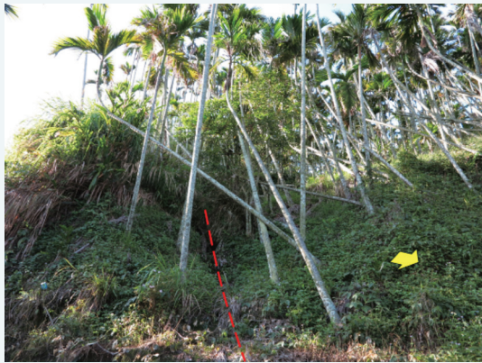
相較左側直立的樹木，彎曲的樹木反映右側曾經滑動過，邊界處（紅色虛線）形成小崩崖。
