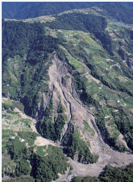
民國 95 年 0609 豪雨造成南投縣仁愛鄉翠巒地區大規模山崩，可明顯觀察到剛發生的岩體滑動、岩屑崩滑及土石流動的現象，照片下方尚有小規模的堰塞湖。
