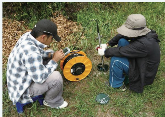
傳統的測傾管量測方式，需仰賴人力攜帶繁重的測傾儀及纜線，進行定期量測。
