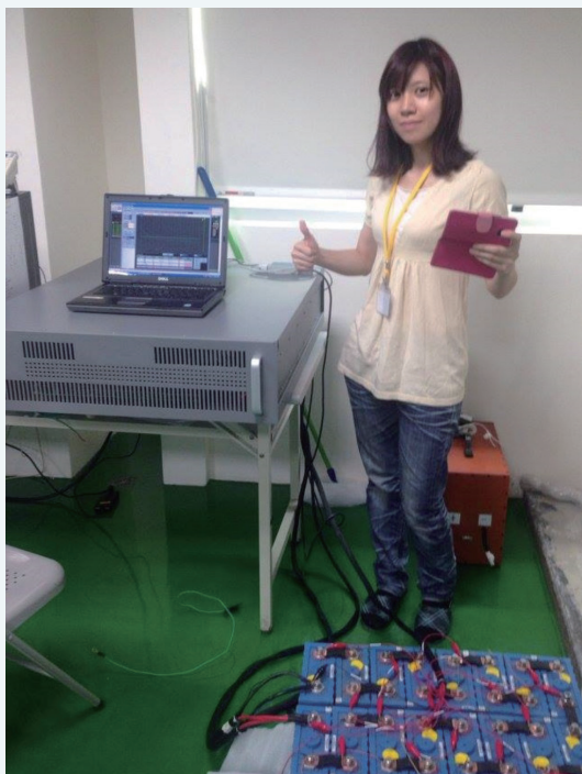
試乘以磷酸鋰鐵電池驅動的純電動越野車（上圖），檢測回收電池組成的儲能電池組（下圖）。
