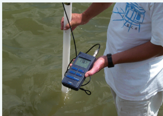
漁民在文蛤養殖池測量氧化還原電位，依底土狀態立刻進行養殖管理。
