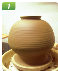
1 以拉坯成形方式製作陶壺外型（圓形平底無耳壺）及拉出甕蓋。
