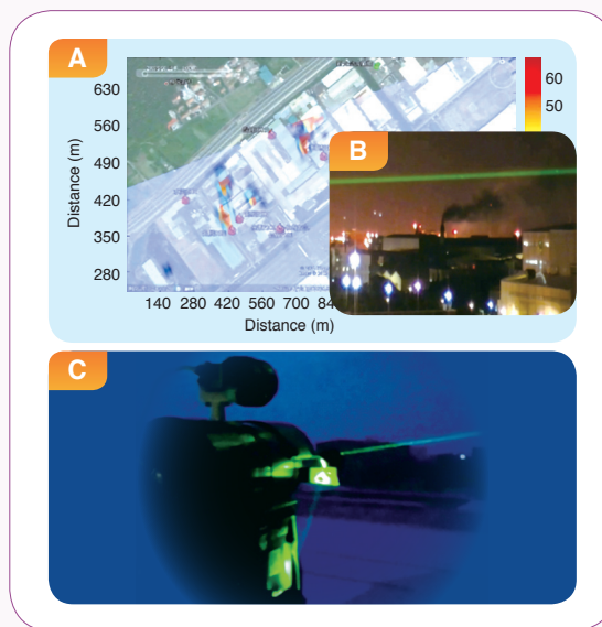
(A) 掃描式光達量測污染濃度與位置，(B) 污染影像錄影和 (C) 光達運作情形。
