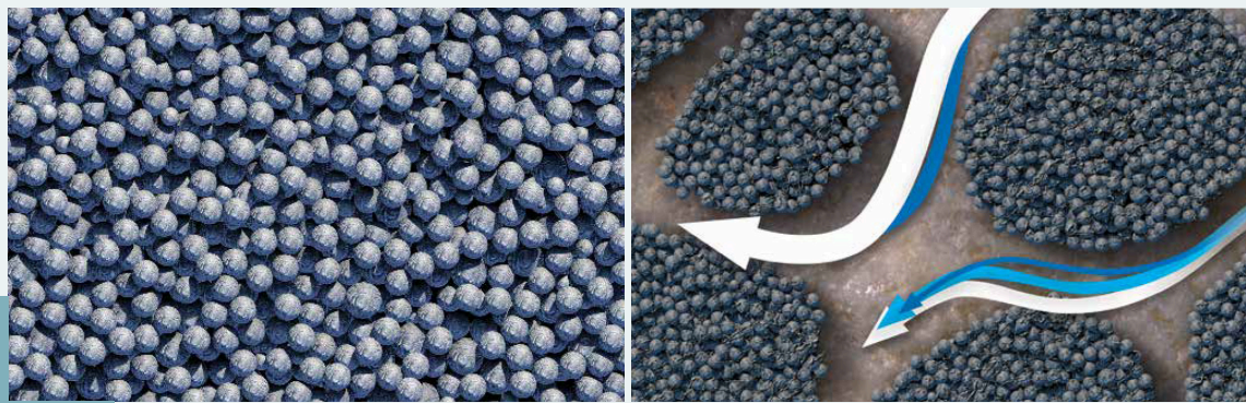
傳統支撐劑（左圖）與新型態支撐劑技術（右圖）所形成的油氣通道比較圖。（圖片來源：Schlumberger 石油服務公司）
