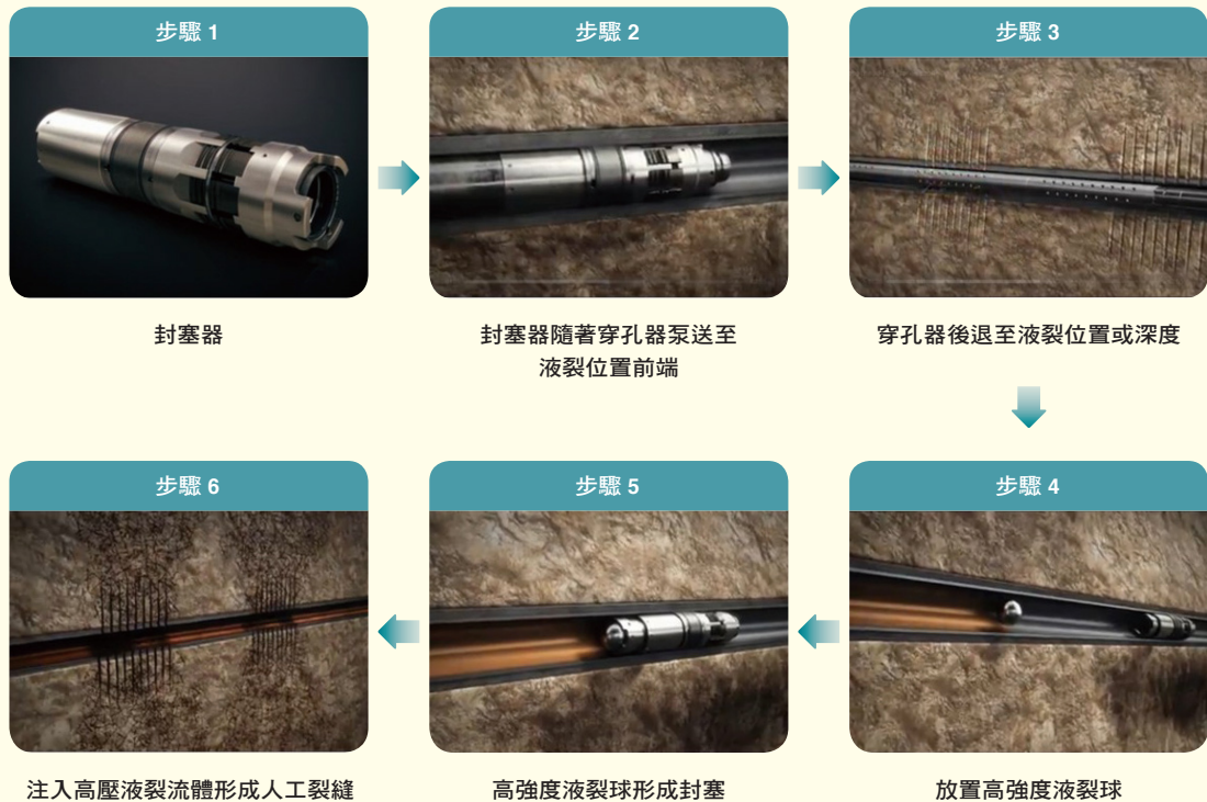
水平井多階段液裂的施作步驟（圖片來源：Schlumberger 石油服務公司）
