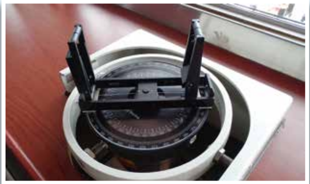
觀測目標方位的方法是把方位圈（Azimuth circle）架設在電羅經的複示器上讀出目標方位。（圖片來源：陳彥宏）
