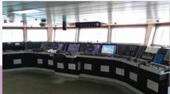
把各種航海儀器的介面整合在一組控制面板上的整合航海系統駕駛台
