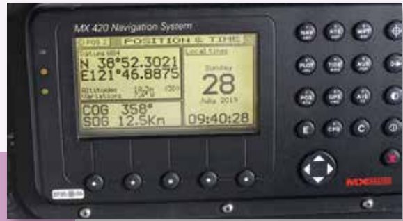
全球定位系統藉由接收來自人造衛星的無線電波資訊，計算出船舶所在的位置。
