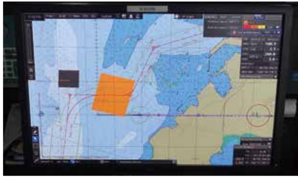
電子海圖資訊系統是利用資料套疊的方式，分別儲存需要的訊息，依使用者需求顯示。
