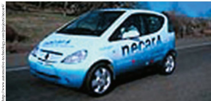
以液氫為燃料，採用質子交換膜燃料電池來發電的第四代燃料電池新電動車NECAR4（new electric car），在路上行駛的情形，它極速可達每小時140公里，加足一次燃料可行駛450公里，同時可搭乘五人。
