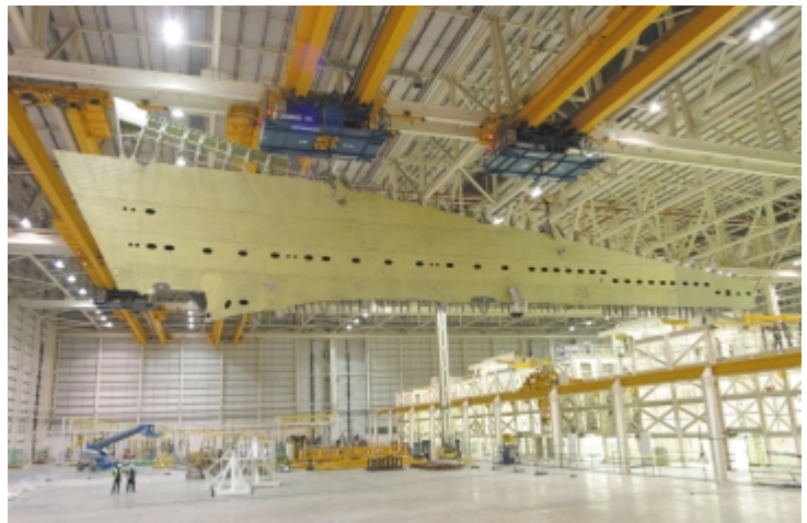
A380主機翼組裝：翼前緣長度超過45公尺，寬11公尺，在機翼的根端深度接近3公尺（這部分將連接機身）。
