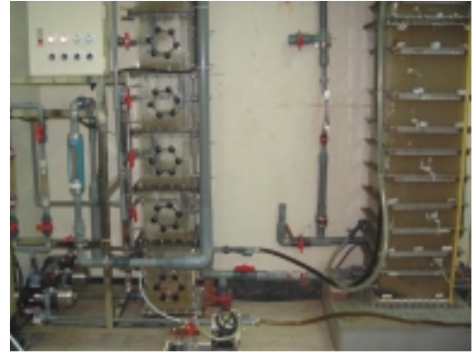
實驗室中的生物洗滌塔 (左) 及氧化洗滌液中有機物的活性污泥槽 (右)
