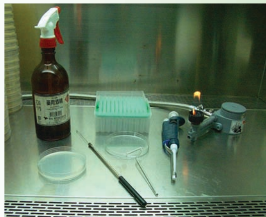
酒精、平板培養基、接種環、玻璃塗抹棒、本生燈和微量吸取器都是微生物實驗的常用器材。
