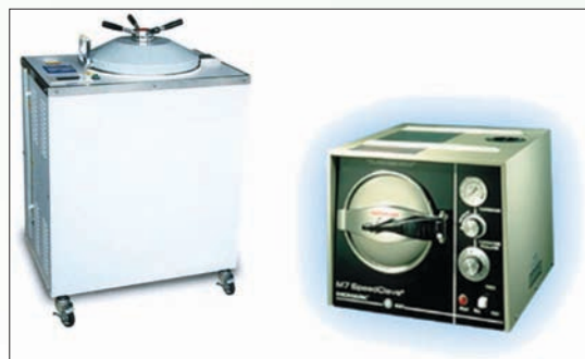
直立型（左）和桌上型（右）滅菌釜能利用高溫和高壓進行各類微生物器材的滅菌處理。
