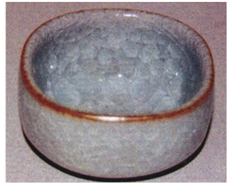
由於胚與釉的熱膨脹相差太大，導致釉面龜裂開片。但如果控制得好，可以製作出釉面宛如玫瑰花瓣、多層次有立體感的冰裂紋釉。
