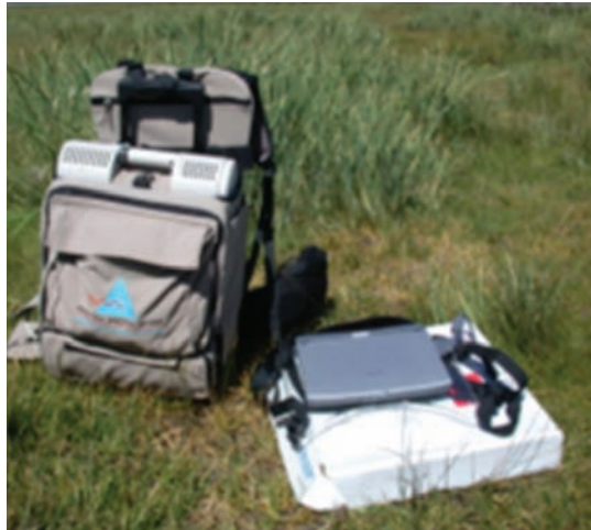
ASD 光譜儀及利用它來測量地物(圖中是牧草)光譜反射的方式
