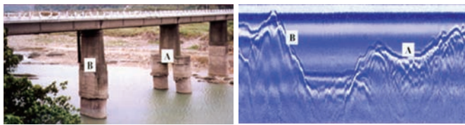
使用透地雷達在河面上掃描而過，可測得河床斷面深度，並研判基礎附近冲刷情形。
