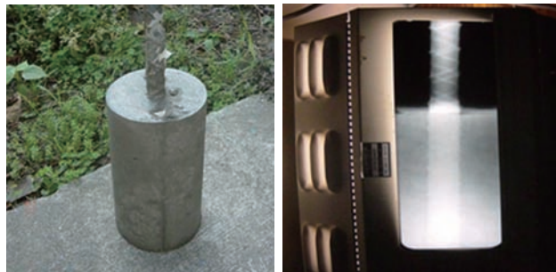
在一些用應力波檢測理論方法不易研判構件內部組成的情況下，可使用放射線照相法，讓內部組成如孔洞、鋼筋尺寸、混凝土保護層厚度一目了然。
