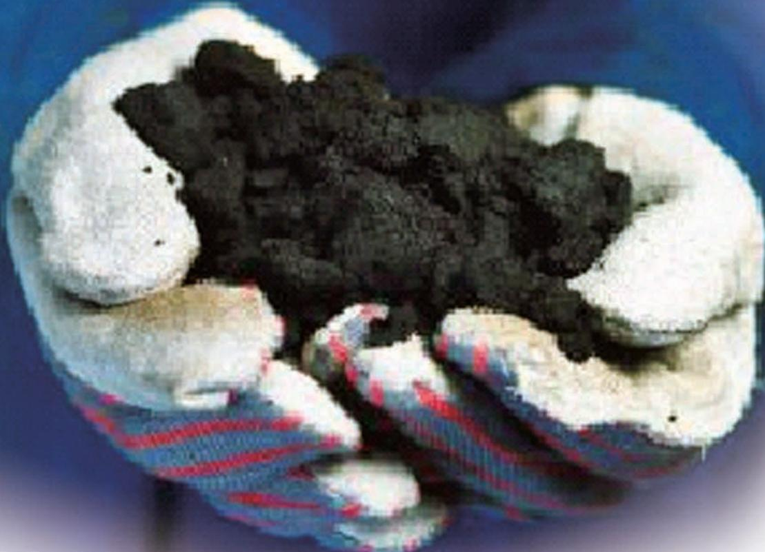
現場挖掘出來的油砂瀝青是黑褐色固體塊狀物，利用高溫蒸氣可使瀝青原油和砂石分離。
