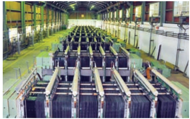
電透析海水淡化設備
