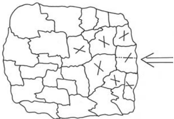
閃玉的多晶互鎖組織使撞擊的外力產生分叉的效應，被削弱的外力多半只能沿解理面產生微尺度裂隙，造成玉石無與倫比的高韌度。
