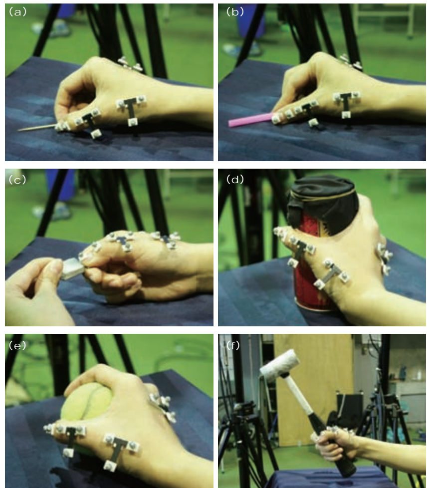
以三度空間動作分析系統可以分析常見的手部日常生活動作：(a) 拿牙籤動作是指尖夾法；(b) 拿吸管動作是指腹夾法；(c) 開鑰匙動作是指側夾法；(d) 拿易開罐動作是柱狀抓握；(e) 拿球動作是球形抓握；(f) 拿鐵鎚動作是強力抓握。
