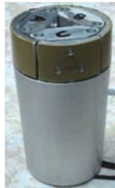
開罐模擬器的內部結構包含3個六軸荷重感測器及1個扭力計
